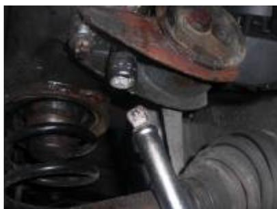
linkes Motorlager (Fahrerseite; zwei E14 Schrauben)
