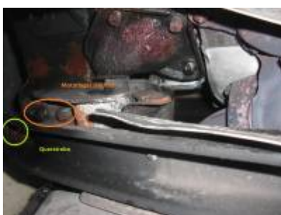
rechtes Motorlager und Querstrebe; zwei Schrauben mit E14 für das Lager
