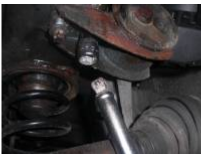
linkes Motorlager (Fahrerseite; zwei Schrauben mit E14)
