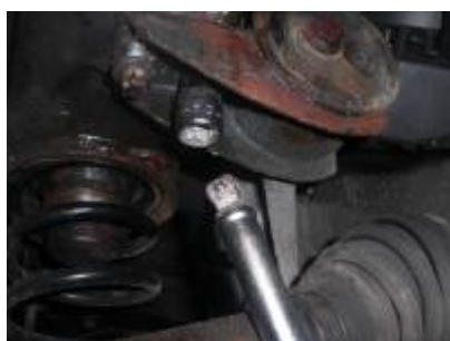
linkes Motorlager (Fahrerseite; zwei Schrauben mit E14)
