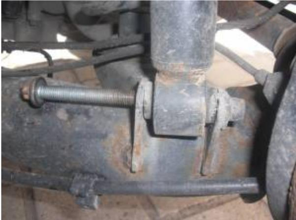
Obere Schraube lösen. Altteil raus, Neuteil rein festschrauben. Fertig. Drehmoment beim Rad 110 NM.
