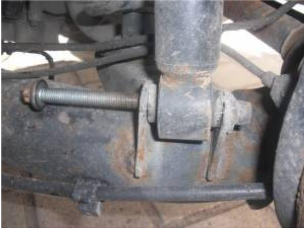
Obere Schraube lösen (viel einfacher, wenn das Radhaus ausgebaut wird, Größen wie untere Schraube). Alteil raus, Neuteil rein festschrauben. Fertig. Drehmoment beim Rad 110 NM.
