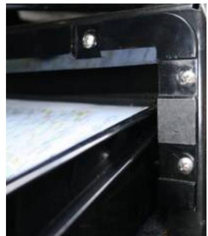
Die Einfachste Montage ist, die schrauben vorher ohne Schublade in die Löcher zu schrauben, um ein passendes Gewinde zu schneiden.
