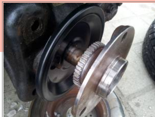
Radlager aufgesteckt, jedoch noch nicht montiert
