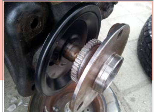
Radlager aufgesteckt, jedoch noch nicht montiert
