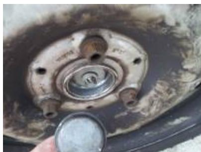
Zentrale Achsschraube leicht lösen, ebenfalls die Radmutter. Dann Smart aufbocken. Oder erst aufbocken und Schlagschrauber nehmen. Bremssattel ausbauen und aufhängen, siehe Anleitung zur Erneuerung der Bremse. Scheibe abnehmen.
