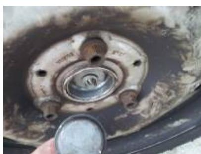
Zentrale Achsschraube leicht lösen, ebenfalls die Radmutter. Dann Smart aufbocken. Oder erst aufbocken und Schlagschrauber nehmen. Bremssattel ausbauen und aufhängen, siehe Anleitung zur Erneuerung der Bremse. Scheibe abnehmen.
