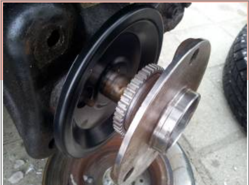
Radlager aufgesteckt, jedoch noch nicht montiert
