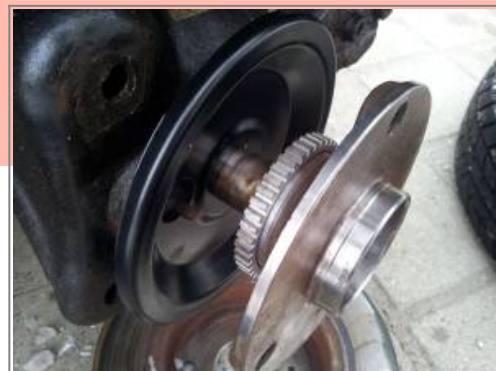
Radlager aufgesteckt, jedoch noch nicht montiert
