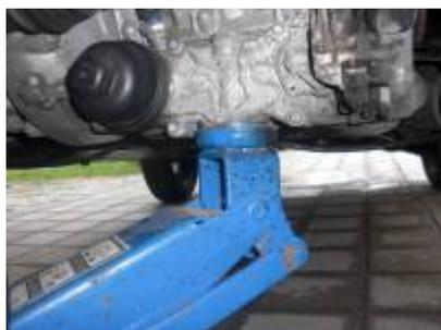
Wagenheber umsetzen! In der anderen Position kommt der Motor beim lösen des rechten Lagers (Beifahrerseite) runter gesackt. Nicht schlimm, aber Adrenalinkick garantiert.
