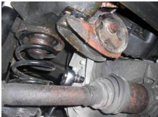
Hier sind die anderen drei E12. Die hintere (Foto) hat eine Tücke - mit der Ratsche ganz raus geschraubt, liegt die Ratsche nun samt Schraube an der Feder an und kann daher nicht mehr entnommen werden. Fazit: Das letzte Stück mit der Hand oder einem Ringschlüssel (zur Not Sechskant) rausschrauben.
