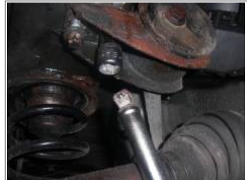
Tausch des hinteren Motorlagers
