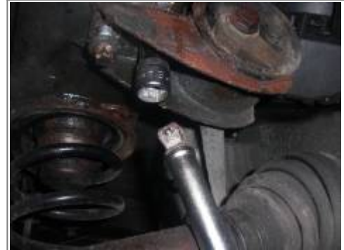
Tausch des hinteren Motorlagers
