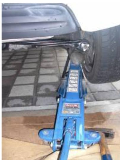
Nachdem das Lager montiert ist, Wagenheber auf das Achsrohr setzten, anheben und Querstrebe montieren.
