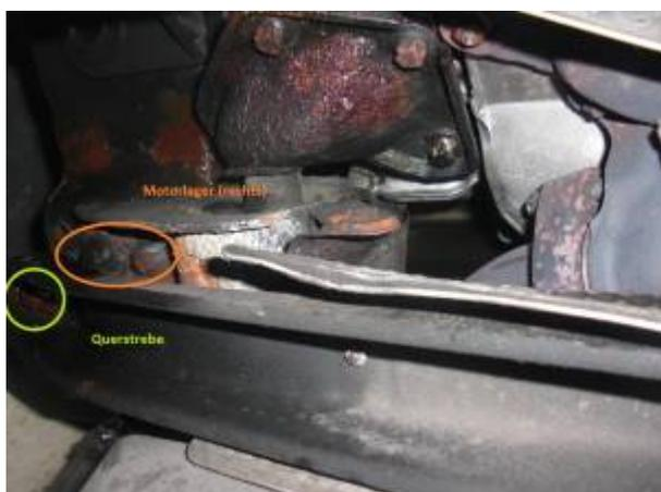
Nun (die auf dem Bild ganz links liegende und gelb markierte) E14 Schraube an der Querstrebe lösen (kommt etwas runter gesackt. Nicht schlimm. Ggf. zweiten Wagenheber unter Achsrohr). Danach wie auf
