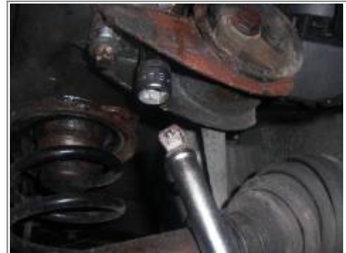
Tausch des hinteren Motorlagers
