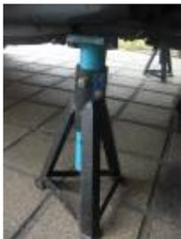
Den Wagen auf den Böcken ablassen. Rütteln, ob Fahrzeug sicher steht und wieder einen Hub nach oben. Nochmals am Fahrzeug rütteln respektive auf sicheren Stand prüfen.
