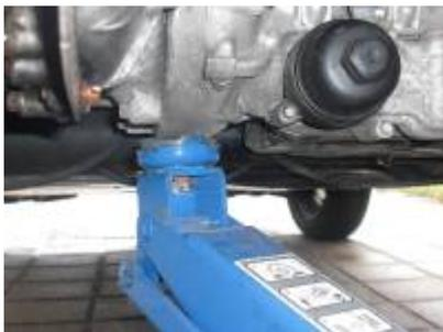
Wagenheber am Getriebe ansetzen
