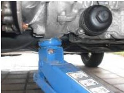
Wagenheber am Getriebe ansetzen
