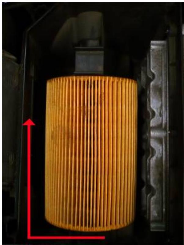
Nach einsetzen des neuen Filters muss das Rohr auf der Seite des Ansaugtraktes wieder in den Filter
