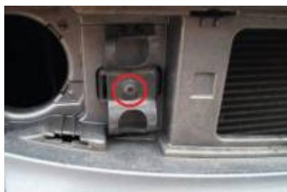
Nachdem alle 4 Schrauben gelöst sind, muss das Frontpanel noch vom Unterboden getrennt werden, in den es eingeclipst ist.
