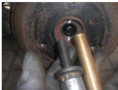
Auf dem Bild sieht man, dass die Welle bereits „ausgeklopft“ wurde. Hierzu habe ich den HAZET Messingdorn 2534 verwendet. Sicherlich geht auch ein anderes Werkzeug, eine Verlängerung vielleicht. Habe mich für den Ausbau der Welle entschieden, weil ich Beschädigungen an der Manschette (Gummi an der Antriebswelle) vermeiden wollte. Auf der Beifahrerseite mit der langen Welle wäre dies evtl. nicht mehr nötig gewesen.
