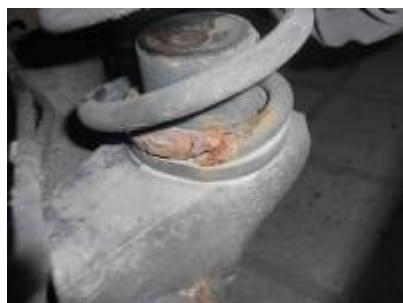
Dieser Übeltäter wurde beim Reifenwechsel entdeckt. Immer eine gute Gelegenheit mal nach dem Rechten zu sehen (Federung, Zustand Bremsleitungen...). Es besteht die Gefahr, dass das Bruchstück während der Fahrt herunterfällt und den Reifen beschädigt.
