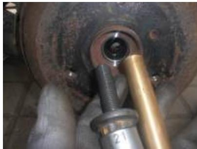
Auf dem Bild sieht man, dass die Welle bereits „ausgeklopft“ wurde. Hierzu habe ich den HAZET Messingdorn 2534 verwendet. Sicherlich geht auch ein anderes Werkzeug, eine Verlängerung vielleicht. Habe mich für den Ausbau der Welle entschieden, weil ich Beschädigungen an der Manschette (Gummi an der Antriebswelle) vermeiden wollte. Auf der Beifahrerseite mit der langen Welle wäre dies evtl. nicht mehr nötig gewesen.
