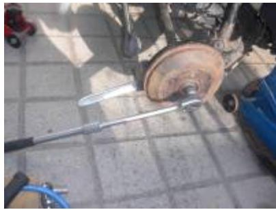
Ohne einen langen Hebel ist man hier bereits aufgeschmissen. Die zentrale Radschraube wird mit einer Vielzahnnsu Grösse 21 bedient.
