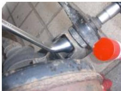
Mit Ringschlüssel kontern SW 17
