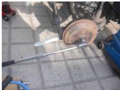
Ohne einen langen Hebel ist man hier bereits aufgeschmissen. Die zentrale Radschraube wird mit einer Vielzahnmutze Grösse 21 bedient.
