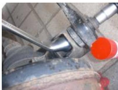
Mit Ringschlüssel kontern SW 17
