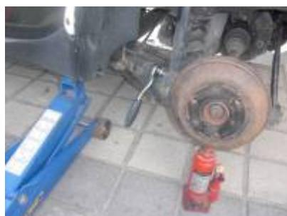
Radschrauben mit 15er Schlüssel lösen, Aufbocken, Rad abnehmen und Bremstrommel mit zweiten Wagenheber absichern. Vergisst man dies geht die Schraube des Dämpfers (siehe auch nächstes Bild) zum Ende zu ziemlich schwer und die Trommel kommt schwungartig runter. Unschön aber nicht weiter schlimm.
