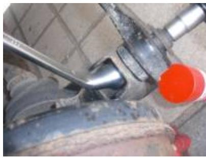
Mit Ringschlüssel kontern SW 17
