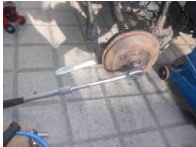
Ohne einen langen Hebel ist man hier bereits aufgeschmissen. Die zentrale Radschraube wird mit einer Vielzahnmutze Grösse 21 bedient. Man kann diesen Schritt vorziehen, und die zentrale Achsschraube bereits lösen bevor das Rad demontiert wird.
