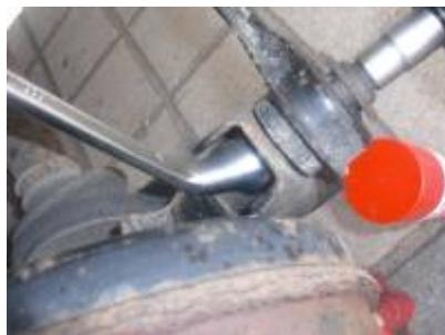
Mit Ringschlüssel kontern SW 17
