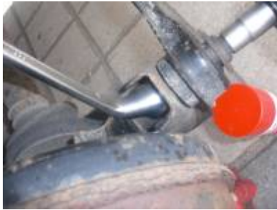
Mit Ringschlüssel kontern SW 17
