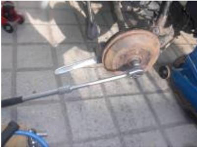
Ohne einen langen Hebel ist man hier bereits aufgeschmissen. Die zentrale Radschraube wird mit einer Vielzahn nuss Grösse 21 bedient. Man kann diesen Schritt vorziehen, und die zentrale Achsschraube bereits lösen bevor das Rad demontiert wird.
