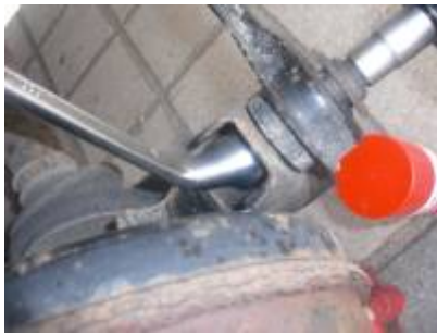
Mit Ringschlüssel kontern SW 17
