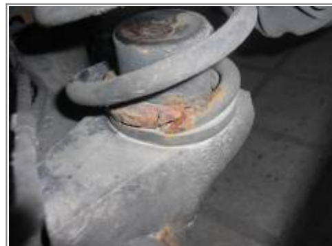
Erneuern der hinteren Federn
