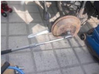
Mit einer Vielzahnness Grösse 21 (gekröpfter Ringmaulschlüssel mit Hebel ging auch) die zentrale Achsschraube demontieren. Diese kann wieder verwendet werden. Anschließend mit einer SW 15 Nuss die Radschrauben öffnen, Smart anheben, absichern und Räder demontieren (auf dem Foto ist das Rad schon ab - geht ebenfalls).
