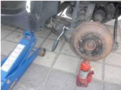
Trommelbremse/Achsrohr mit Wagenheber etwas abstützen.
