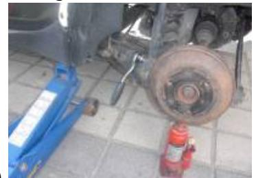
festgegammelt. Ein Traum! Größe E14 (Torx) Trommelbremse mit Wagenheber etwas abstützen.
