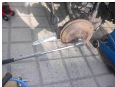
Mit einer Vielzahnnuss Grösse 21 (gekröpfter Ringmaulschlüssel ging auch, es müsste ein Rohr oder so aufgesteckt werden um die Hebelwirkung zu bekommen) die zentrale Achsschraube wechseln. Diese kann wieder verwendet werden. Anschließend mit einer SW 15 Nuss die Radschrauben öffnen, Smart anheben, absichern und Räder demontieren (auf dem Foto ist das Rad schon ab - geht ebenfalls).
