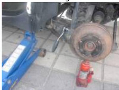
Größe E14 (Torx) Trommelbremse mit Wagenheber etwas abstützen.
