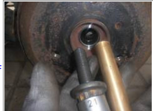
Erneuern des ABS-Rings / der Antriebswelle
