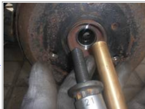
Erneuern des ABS-Rings / der Antriebswelle
