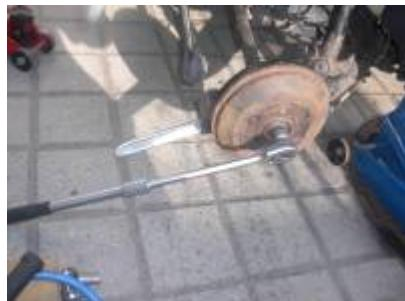
Mit einer Vielzahnnuss Grösse 21 die zentrale Achsschraube wechseln. Diese kann wieder verwendet werden. Anschließend mit einer SW 15 Nuss die Radschrauben öffnen, Smart anheben, absichern und Räder demontieren (auf dem Foto ist das Rad schon ab - geht ebenfalls).
