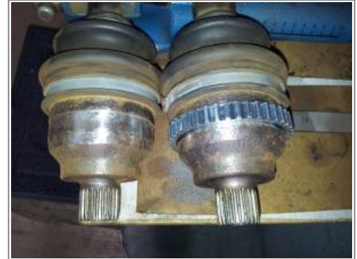
Erneuern des ABS-Rings auf die Welle
