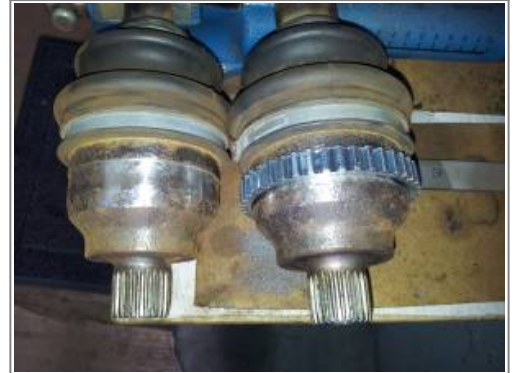
Erneuern des ABS-Rings auf die Welle
