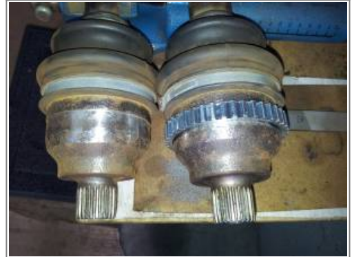
Erneuern des ABS-Rings auf die Welle
