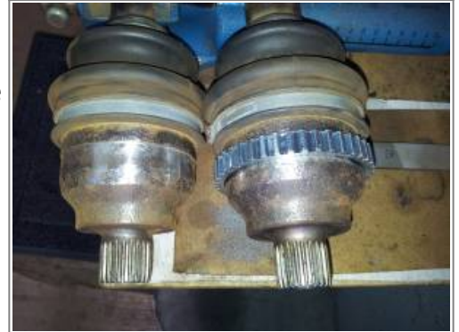
Erneuern des ABS-Rings auf die Welle
