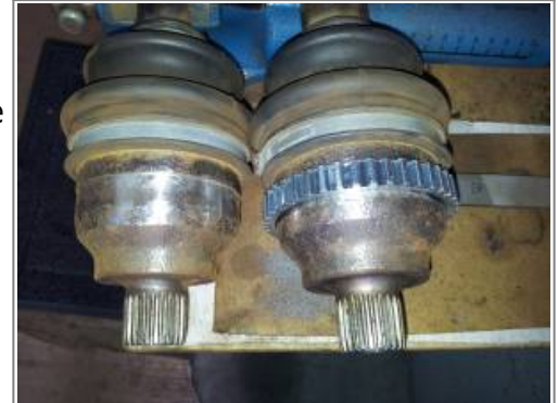
Erneuern des ABS-Rings auf die Welle
