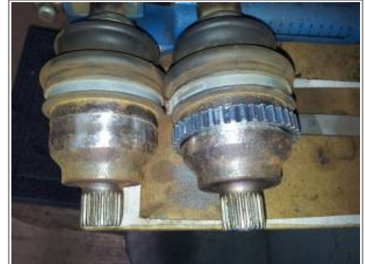
Erneuern des ABS-Rings auf die Welle
