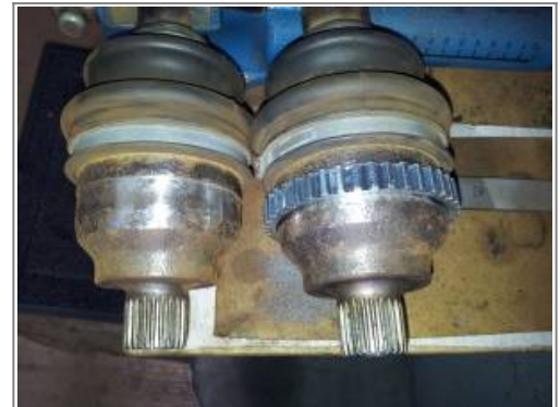
Erneuern des ABS-Rings auf die Welle
