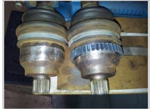
Erneuern des ABS-Rings auf die Welle
