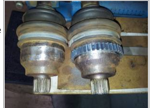
Erneuern des ABS-Rings auf die Welle
