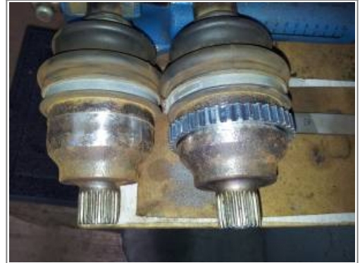
Erneuern des ABS-Rings auf die Welle
