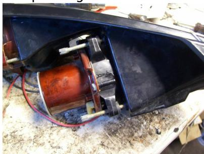
2. mit einem passendem Werkzeug (hier ein Rohr) den alten Scheinwerfer ausbauen. Das Rohr wird so auf die Halterung gedrückt das die Haltenasen der Clipse zusammen drücken und so aus dem Träger lösen lassen.
