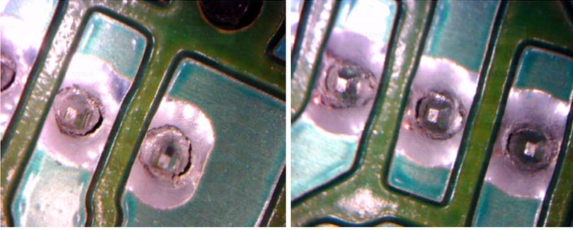
Diese Lötunkte einfach mit Elektroniklot <sup>2)</sup> nach löten und schon funktioniert das wieder. Es können aber auch nur kreisrunde Haarrisse sein die deutlich unspektakulärer aussehen!
