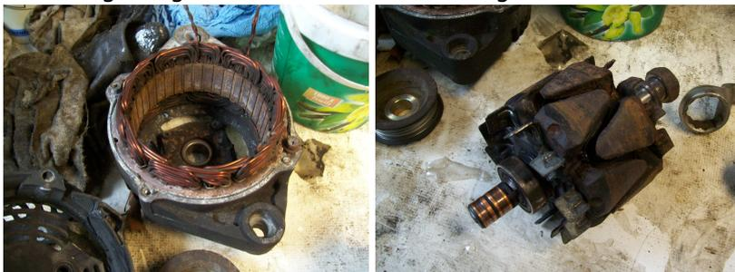
Im Inneren sieht die echt vergammelt aus. Tribut für die ungeschickte Einbaulage. 🙄
