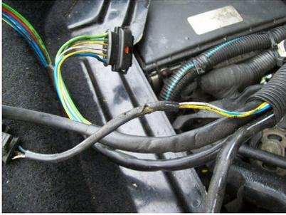
das hier sind die Kabel vom [Drehwinkelsensor](#) die durch waren.
